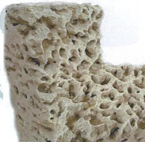
Проницаемость – свойство породы, характеризующее способность пропускать (фильтровать) пластовые флюиды при наличии перепада давления.
